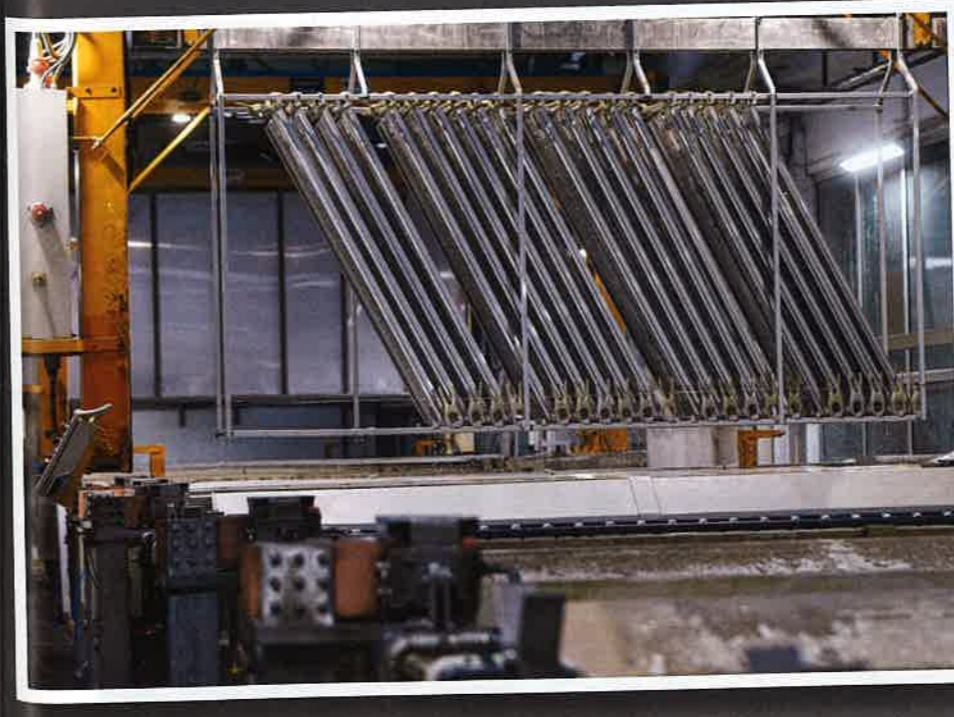
Elokstriranje – najpomembnejša površinska obdelava. Foto: Nino Verdnik
